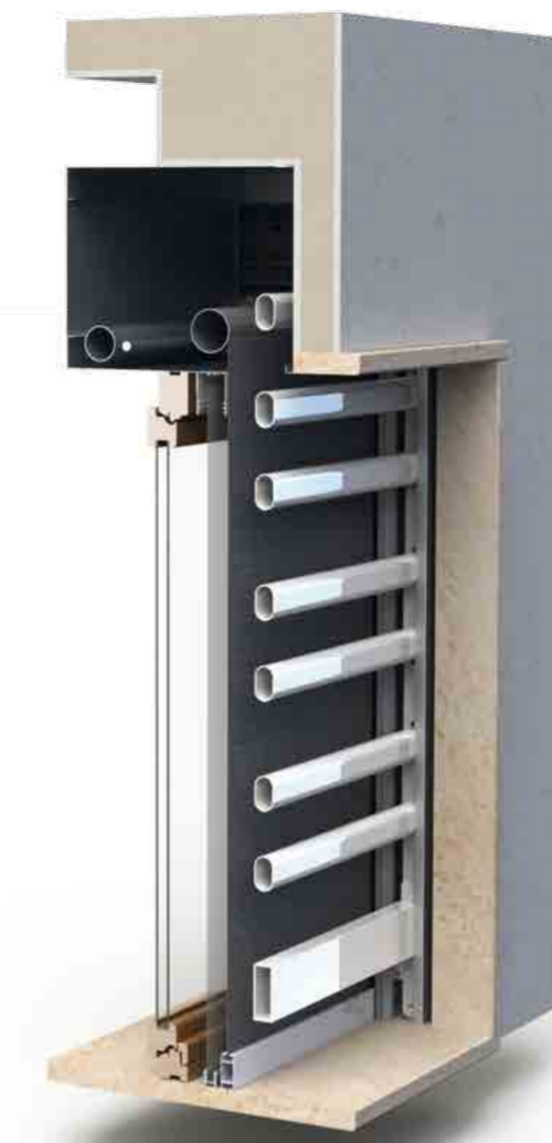
SOLUZIONE GRATA CON PREDISPOSIZIONE PER TELO OSCURANTE E ZANZARIERA
